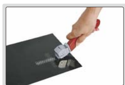
paso 1: hacer cortes de rejilla en la superficie
